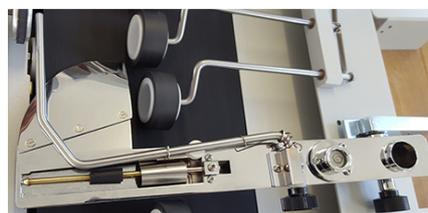
Máquina de fechar cartas que faz o trabalho de 10 pessoas, com um gasto mínimo de cola. Caso o envelope tenha cola, basta colocar água no reservatório apropriado. Esse reservatório regula automaticamente a quantidade de água, ou cola líquida, que deve colocar na zona de colagem. Possui um nível, para indicar quando precisa de ser novamente abastecido.
